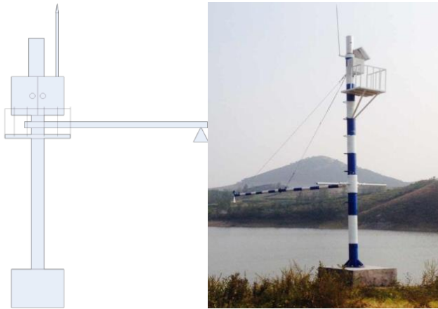
图 3-1 雷达式水位计安装结构示意图图 3-2 雷达式水位计实物图
